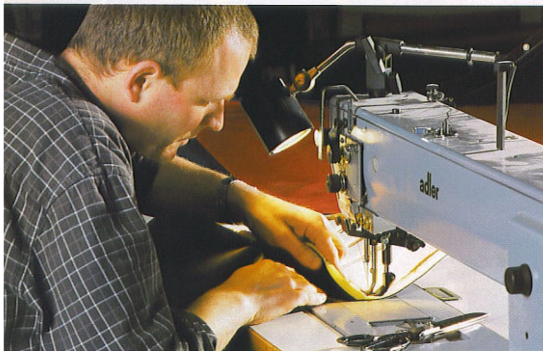
Das beste Stück. Mit einer „Langarm“-Nähmaschine von Adler werden mustergültige Nähte gezogen
